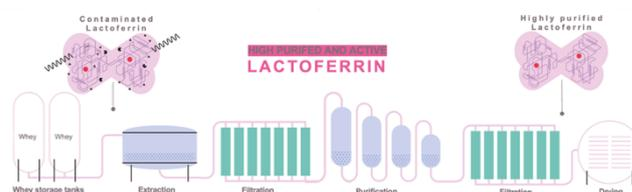
Abb.3.: Produktionsprozess der Mercurius Production GmbH
